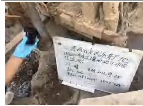
A02 半挥发性有机物样品采集照片
