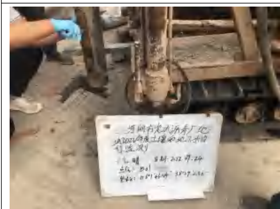
B01 非扰动采样器采样照片
